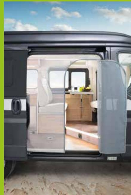
Keine ungebetenen Gäste: Das Moskitonetz schützt effektiv vor Insekten im Fahrzeug und bietet gleichzeitig eine ungehinderte Luftzirkulation. Die Montage ist dank angeschweißten Magneten und den aufgenähten flexiblen Magnetbändern ein Kinderspiel. *(Art. modellabhängig)*
