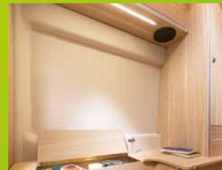
Die Stoffkaschierungen an den Seitenwänden und der Decke machen den Innenraum gemütlicher und wirken zudem isolierend und dämmend.
