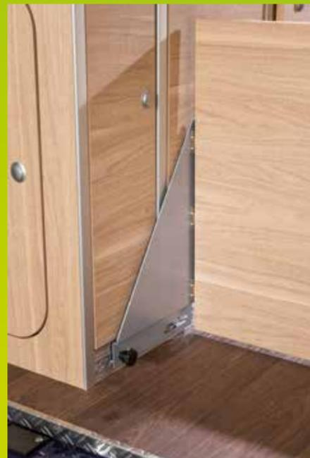
Durch integrierte, hochfeste Aluminium-Zurrschienen mit variablen Ösen und einer variablen Gepäckraum-abtrennung können unterschiedliche Gegenstände auf der Fahrt sicher transportiert werden.
