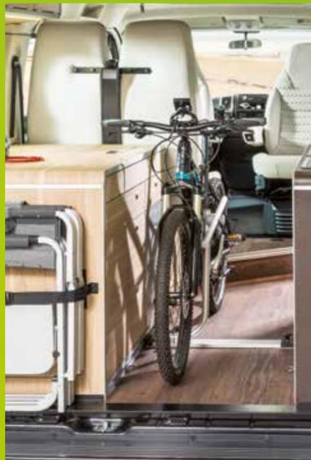
Auf der Fahrradhalterung im Innenraum lassen sich Räder sicher befestigen. Die RadFazz-Halteschiene kann separat bestellt werden. *(Art.-Nr. 2585602)*
