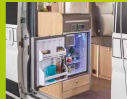
Der Kühlschrank lässt sich bis zu einem Winkel von 180 Grad öffnen und ist somit auch von außen über die Schiebetüröffnung zugänglich.
