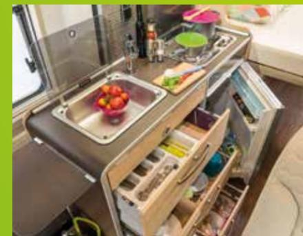
Die Küche ist mit Spüle, integriertem 2-Flammen-Gaskocher und einem 108-Liter-Kompressor-Kühlschrank vollwertig ausgerüstet.
