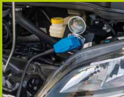
Der Stromanschluss befindet sich dezent im Motorraum des Fahrzeugs, um mögliche Gefahrenquellen durch undichte Stellen auszuschließen.
