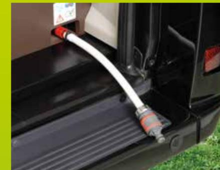
Der praktische Adaptersatz zur Frischwasserbefüllung ermöglicht eine einfache Befüllung mittels eines normalen Gartenschlauchs. *(Art.-Nr. 2452032)*
