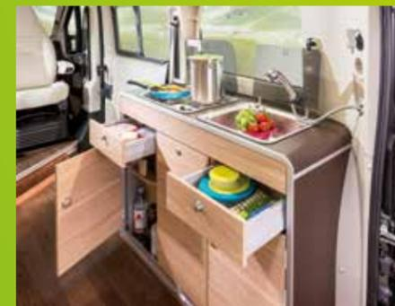
Die Küche ist mit Spüle, integriertem 2-Flammen-Gaskocher und einem 65-Liter-Kompressor-Kühlschrank vollwertig ausgerüstet.
