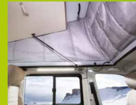
Die 4-teilige Schläfdachisolierung wird mit Klettverschlüssen befestigt. Das Vorderteil lässt sich öffnen, damit für Luftzirkulation und Licht gesorgt ist. *(Art. modellabhängig)*
