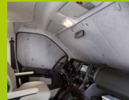
Die 3-teilige Innenisolierung fürs Fahrerhaus schließt mit den Fensterkonturen dicht ab und ist schnell montiert. *(Art.-Nr. 2328870)*
