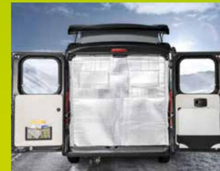
Die klappbare Heckisolierung inkl. Fensterausparung sorgt im Winter für angenehme Temperaturen. Montage wie beim Moskitonetz. *(Art. modellabhängig)*
